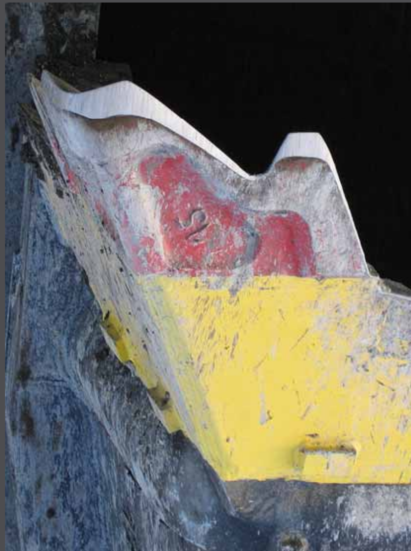
naroże czerpaka utrzymujące poprawną geometrię skrawania w całym okresie zużycia
